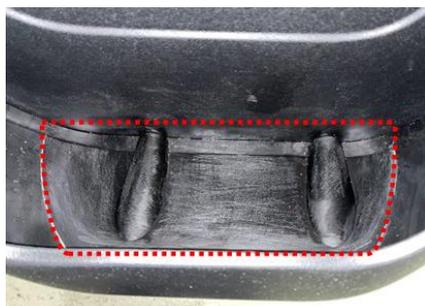
**(DE)** Die Türschale im angezeichneten Bereich anschleifen. Angeschliffenen Bereich mit Körasolv WL reinigen. Ablüßzeit 5 min. einhalten. Auf den gereinigtem Bereich HG 83 auftragen. Ablüßzeit HG 83 10 min. einhalten. Zum Reinigen und Auftragen der Mittel, Soft-Light-Tuch verwenden.
