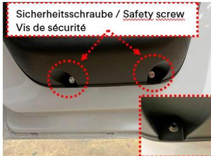
(DE) Die Torxschrauben an der Verkleidung ersetzen durch Sicherheitsschrauben. Alle 4 Schrauben werden ersetzt.
